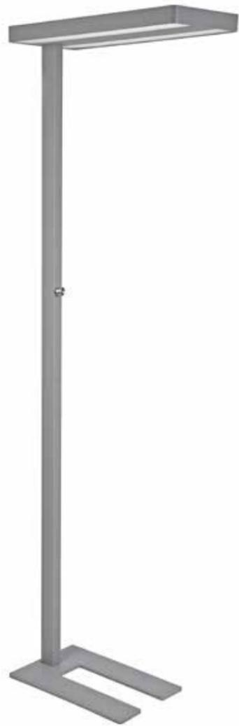
**ATON S** – LED-Stehleuchte mit 50% indirekter und 50% direkter Lichtverteilung, mit Tageslicht- und Bewegungssensor, stufenlos einstellbarer Dimmer, 4000 Kelvin, neutralweißes Licht, gewichteter Energieverbrauch 80 kWh/1000h, Gestell Aluminium, Standfuß, Energieeffizienzklasse A+
